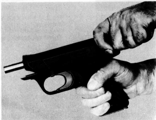
Fig. 4: Pull back the slide Retroceder la corredera Tirer le bloc-culasse vers l'arrière
