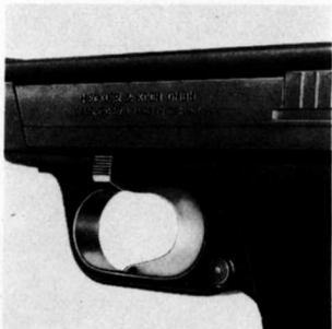
Fig. 2: Safety on Seguro puesto Sûreté engagée
